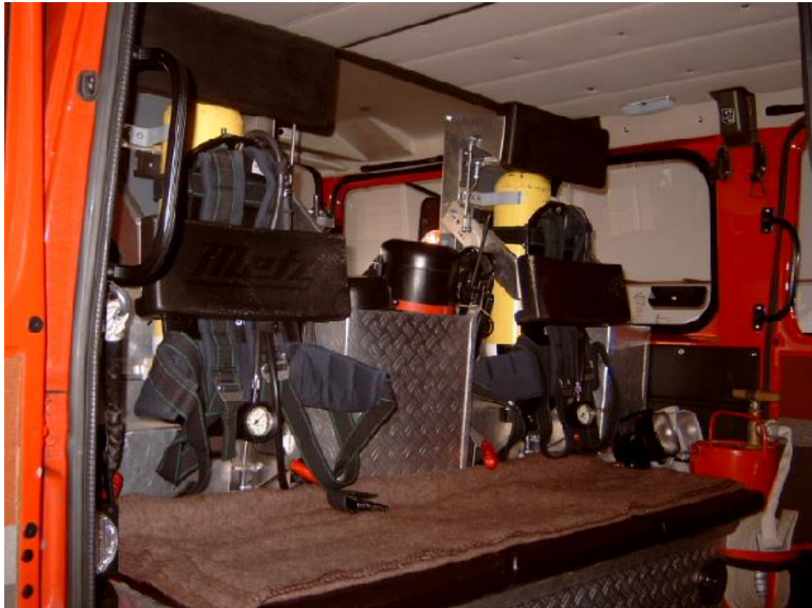
Halterung für Atemschutzgeräte im Fahrzeug
